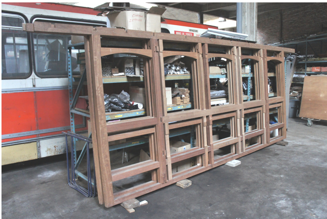
Charpente de caisse en bois fabriquée par le Lycée Saint Exupéry d'Halluin pour la motrice A201 de 1894
